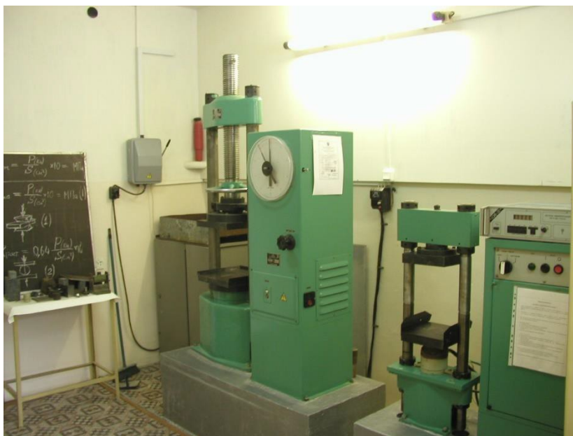
Рис. 1 Прессы в лаборатории физико-механических свойств горных пород
